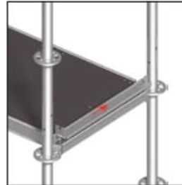
Kalkma önleyici parça kancalar oturana kadar hareket ettirilir.
